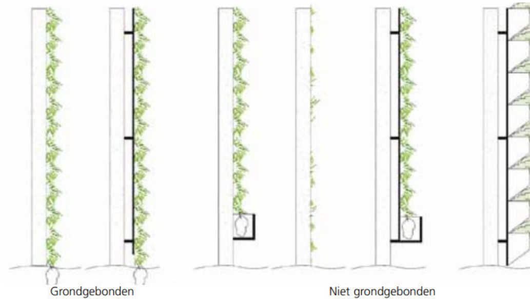
Figuur 4: Typen systemen voor het toepassen van gevelgroen 7
